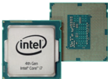
Εικόνα 1.6. Κεντρική Μονάδα Επεξεργασίας
