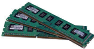
Εικόνα 1.9. Αρθρώματα μνήμης τεχνολογίας DDR
